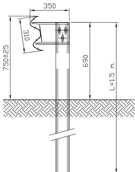
**BARRERA METÁLICA DOBLE ONDA CON SEPARADOR SIMPLE.**
