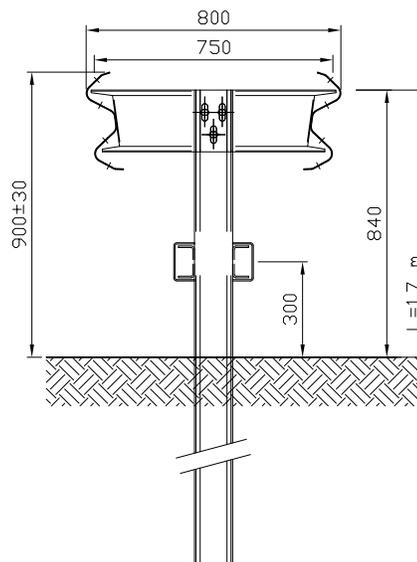
**BARRERA METÁLICA DOBLE ONDA CON TENSOR LONGITUDINAL.**
