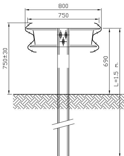
**BARRERA METÁLICA DOBLE ONDA CON SEPARADOR SIMÉTRICO.**
