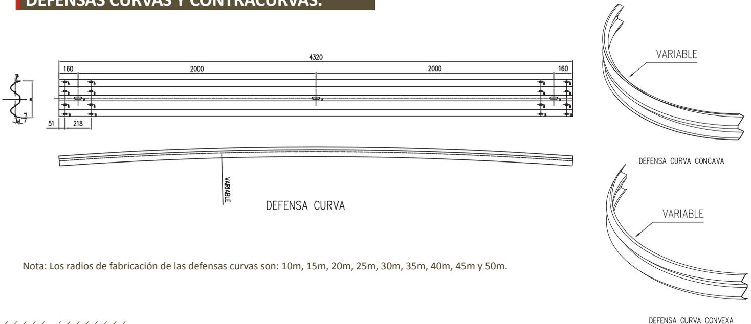
Nota: Los radios de fabricación de las defensas curvas son: 10m, 15m, 20m, 25m, 30m, 35m, 40m, 45m y 50m.
